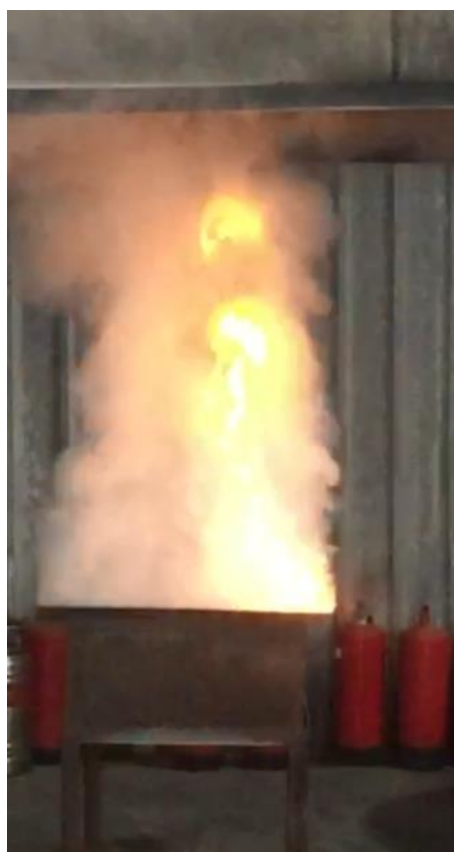
Fig. 5: Secuencia extinción freidora (8 segundos entre fotograma inicial y final)
