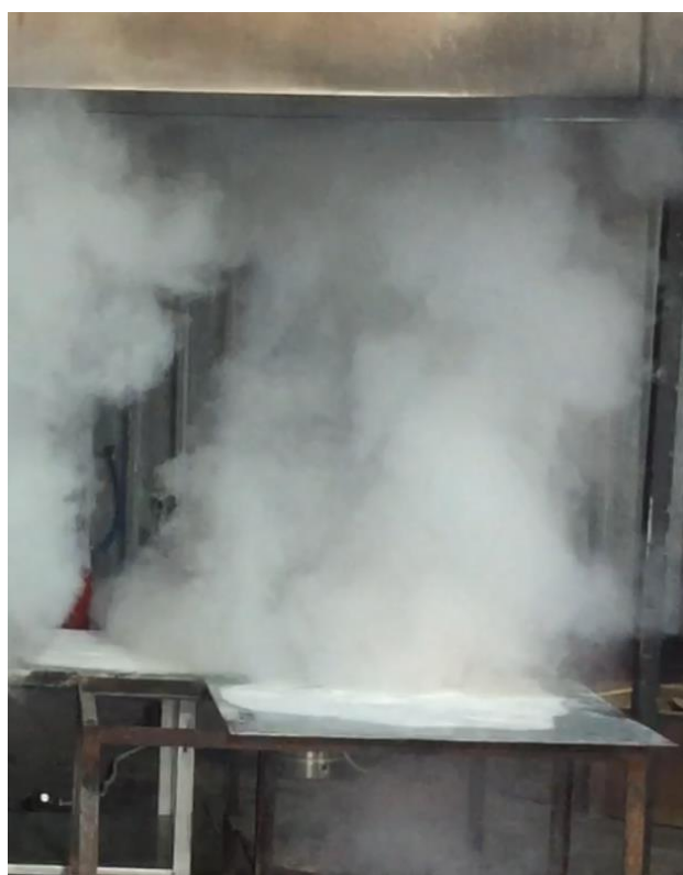
Fig. 9: ensayo salpicadura sartén / hornilla (4 segundos entre inicio y fin).
