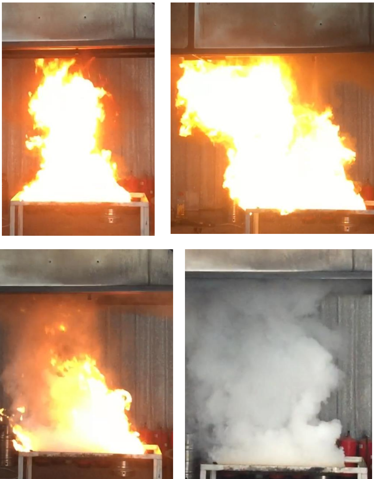
Fig. 6: Ensayo extinción plancha. 9 segundos entre inicio y fin
