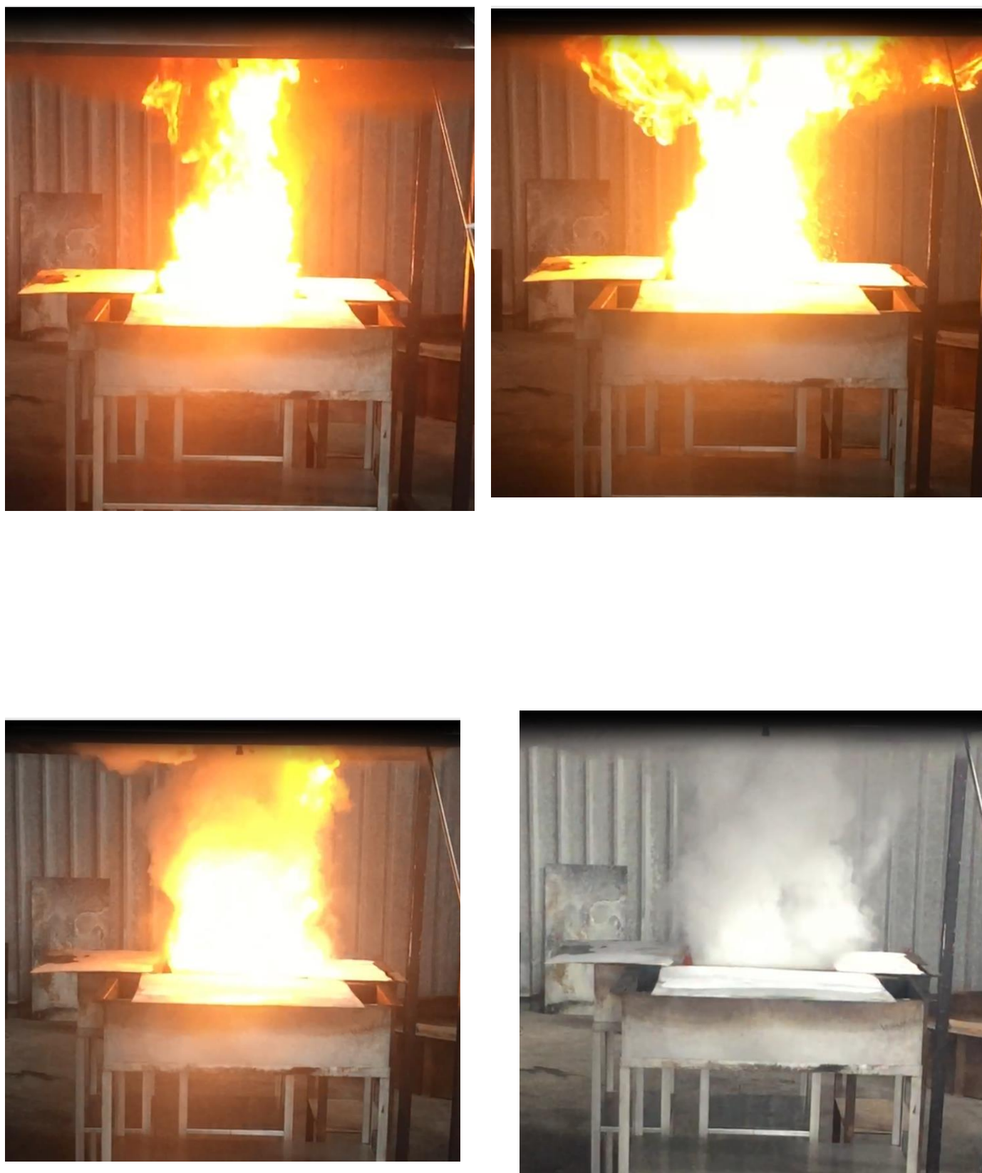
Fig. 9: ensayo salpicadura freidora (6 segundos entre inicio y fin).
