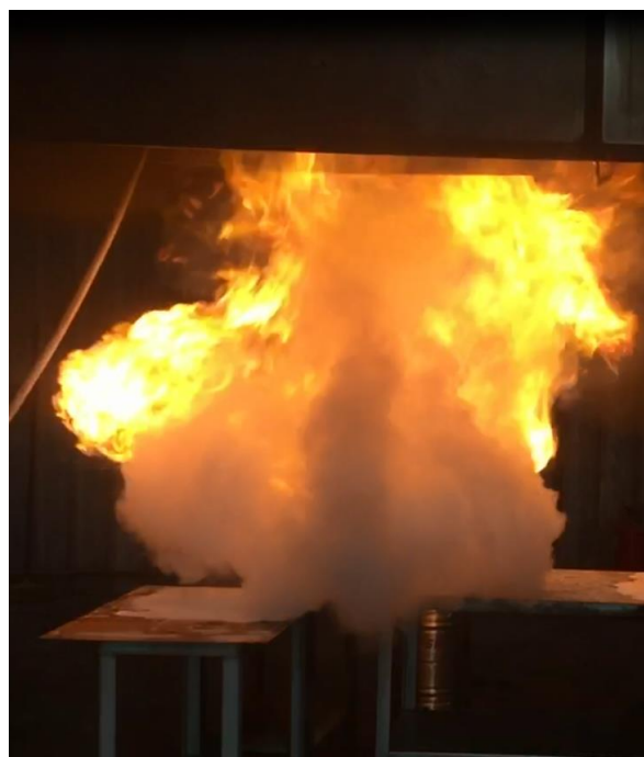
Fig. 9: ensayo salpicadura wok (4 segundos entre inicio y fin).
