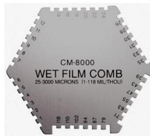
Foto 5 (Equipo medida espesores húmedo)
